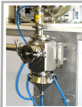
Fließbettgegenstrahlmühl AFG 100 mit integriertem Sichter
