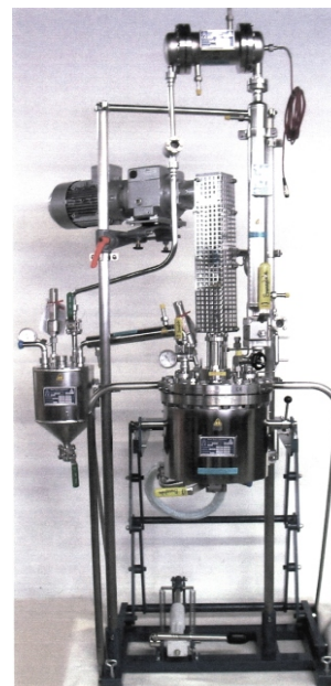
10L-Autoklav zur Um-/Veresterung und Polykondensation
