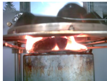
Bild: Cone-Kalorimeter-Strahler mit Probe während der Messung
